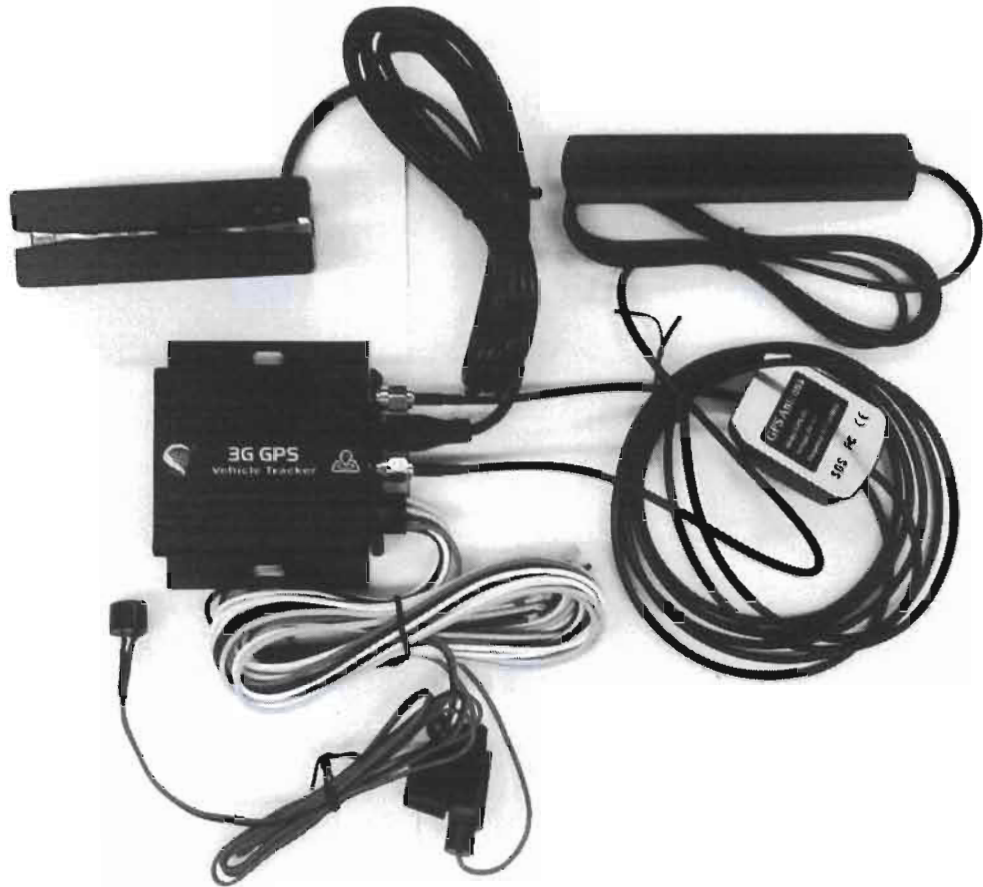
เครื่องบันทึกข้อมูลการเดินทางของรถ ชนิด iStartek แบบ VT900 T เมื่อติดตั้งอุปกรณ์บ่งชี้ผู้ขับรถ ชนิด iStartek แบบ VT900
